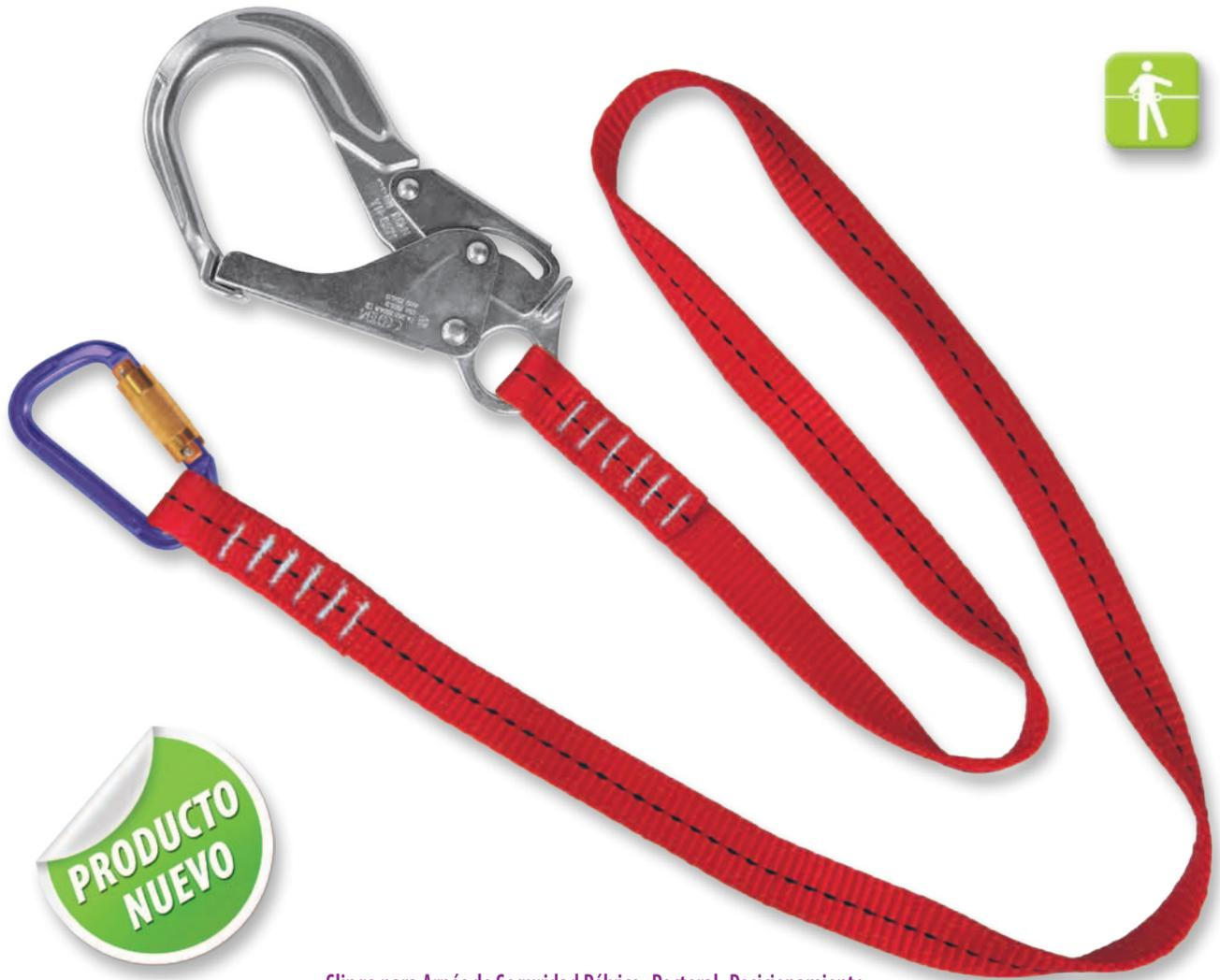
**Slinga para Arnés de Seguridad Pélvico- Pectoral -Posicionamiento- 1.8mt. 1 gancho Grande Fijo de Aluminio Forjado (Apertura 2 1/2") / 1 Mosquetón de Seguridad Duro Aluminio. Riata Poliéster 1" – NO SIRVE PARA DETENER CAÍDAS.**
